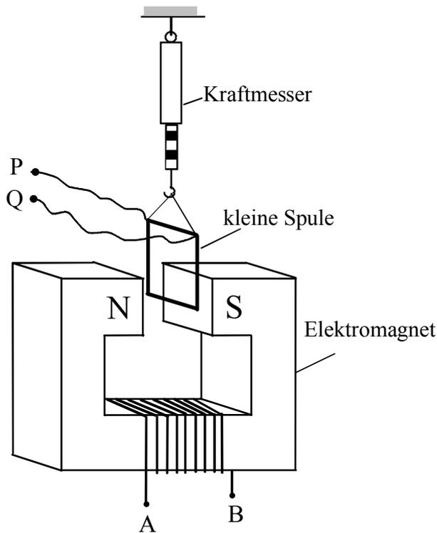
Die Anschlüsse A und B eines Elektromagneten sind mit einer Gleichstromquelle verbunden. Durch die Spule des Elektromagneten fließt ein konstanter Gleichstrom. Nordpol und Südpol des Elektromagneten sind in der nebenstehenden Skizze mit N und S gekennzeichnet.
